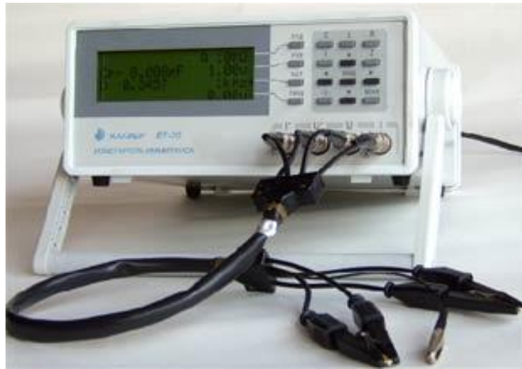
Şəkil 2.9.2. Dielektrik parametrlərinin tədqiqi üçün istidadə olunan E7 – 20 markalı immittans ölçən
