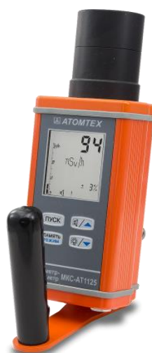
Şəkil 2.4.1 Ərazilərdə radiasiya fonunu müəyyən etmək üçün istifadə edilən dozimetr-radiometr –“MKS-AT1125”
