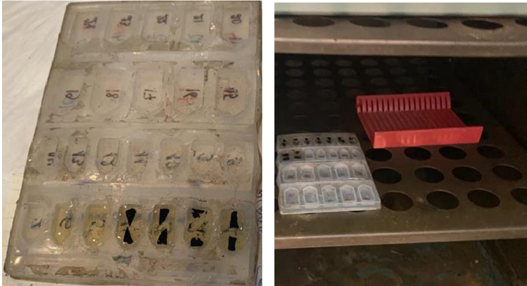
Şəkil 2.9.1. Laboratoriya siçovullarının qaraciyər orqanının KEM-də təsvirinin alınması üçün hazırlanması
