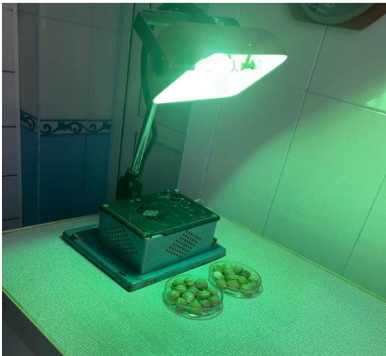
Şəkil 4.3.1. Çanaqlı üzüm ilbizlərinin DRT – 230 civə-kvars lampasında UB radiasiya ilə şüalanması
