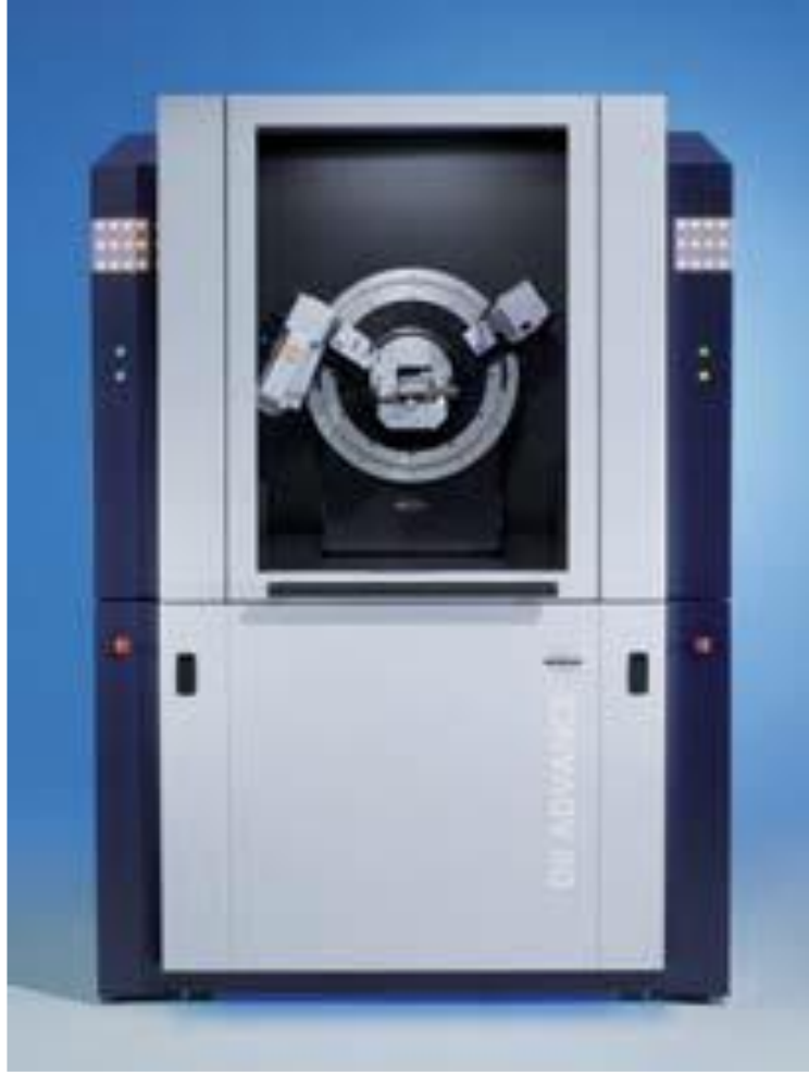
Şekil 2.4.1. D8 Advance rentgen difraktometri.
