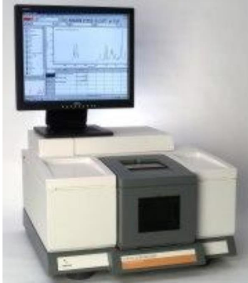
Şekil 2.3.2. Varian 1000 FTİR spektrometri.
