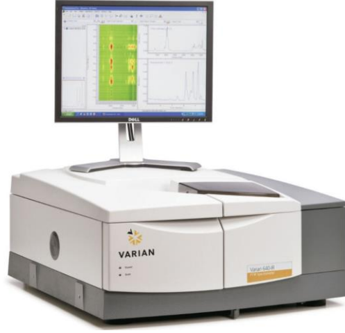
Şekil 2.3.1. Varian 640 FTİR spektrometri.
