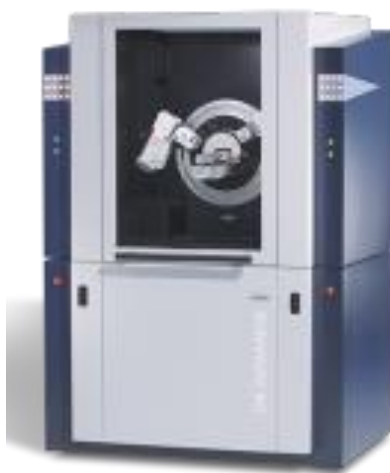
Şəkil 2.2.1. Müstəvilər arası məsafə, qəfəs parametrləri, fəza qrupu və Miller əmsallarının təyin etmək üçün X-Ray (Diffraction D8 Advance) cihazı.
