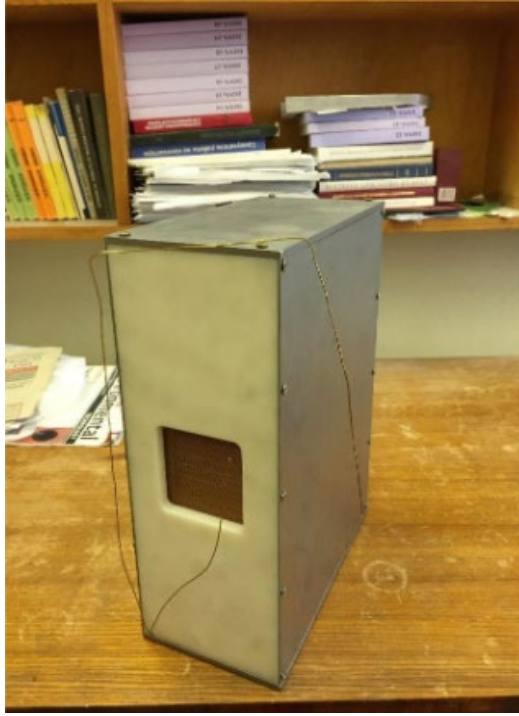
Şəkil 2.5.4. Poliamiddən hazırlanmış solenoidlərin fotosəkili. a) solenoid ferromağnit ekranın içində; b) sarğı zamanı solenoid.
