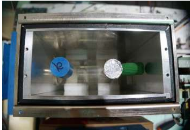
Şəkil 2.5.1. İçərisində SF kolbası olan maqnitostatik ekran [37, s. 4].
