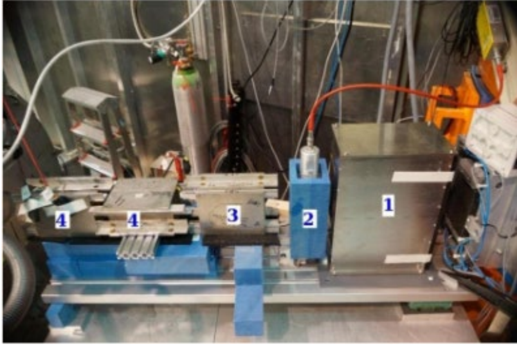
Şəkil 2.7.2. Təcrübi qurğunun fotosəkili. 1 - polyarizator; 2 – neytron sayğacı; 3 – spin flipper; 4 – kompensasiya edici flipperlər.
