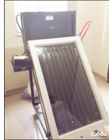
Günəş Su Qızdırıcısının (GSQ) laboratoriya modeli
